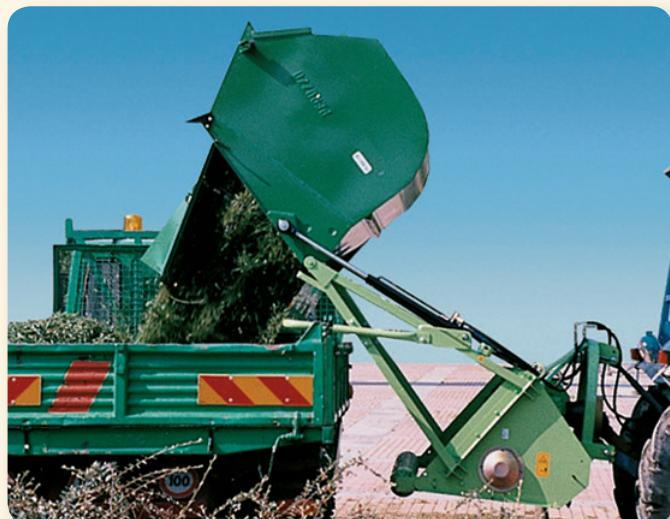
Scarico idraulico fino a 2 mt di altezza tramite il sollevatore del trattore.
