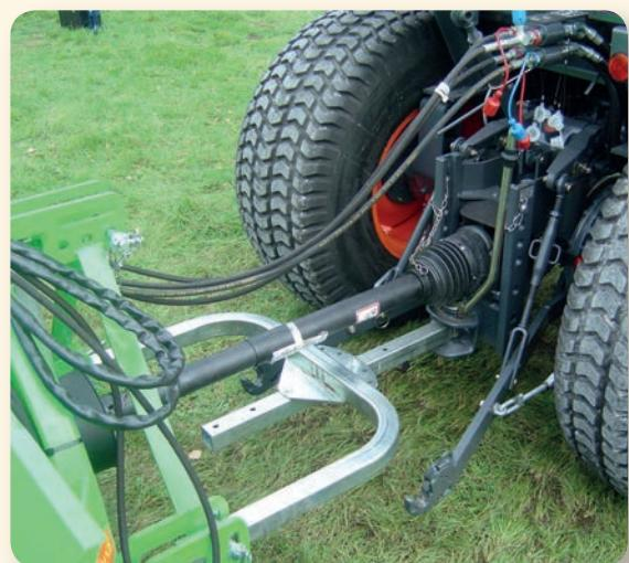
Timone idraulico da utilizzare con cardano omocinetico e/o spazzola idraulica per pulizia bordi stradali. (accessorio)
