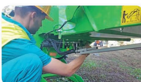
Nuovo sistema di trascinamento potatura tramite catena dentata idraulica.
