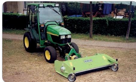
● Gamma di trinciaerba frontali e posteriori per trattori da 12 a 30 CV con larghezze di taglio a 1 a 1,6 mt. Per superfici sportive e comunali. ● Front and rear mounted flail mowers range for 12 to 30 HP tractors with 100 to 1600 cm cutting width. For sport courses and municipality fields.
