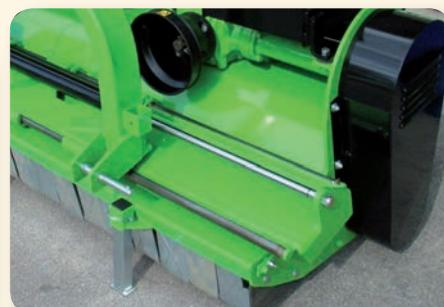
Spostamento idraulico dell'attacco a 3 punti per Bull Super.
