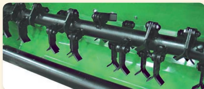
Vista albero coltelli / Flail shaft view. / Vue du rotor / Messerwelle foto
