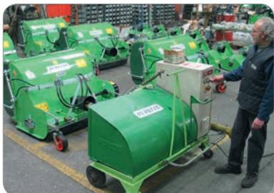
● La Peruzzo pone al primo posto la qualità e la silenziosità delle proprie attrezzature testando ogni macchina prima della spedizione con una speciale motrice elettrica a velocità variabile.
