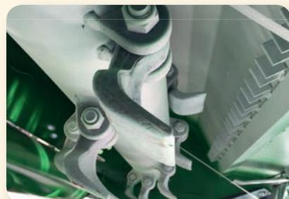
Rotore con mazze per il taglio di erba e triturazione potature. Fino a 4/5 cm di diametro.
