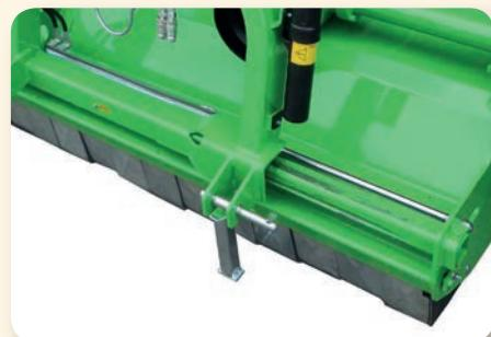
Spostamento idraulico dell'attacco a 3 punti per Bull Reverse.
