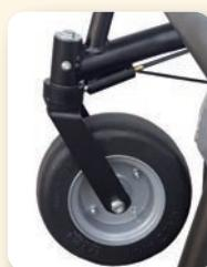
Sistema di bloccaggio ruote anteriori direttamente dalla postazione di comando della tricia.
