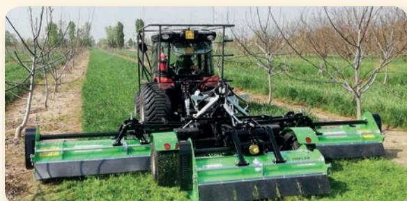
Kit (brevettato) Impianto idraulico alzata trincia laterale con blocco rotore di taglio senza dover fermare la presa di forza del trattore a norma per la massima sicurezza.
