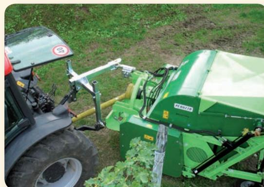
Timone di traino per facilitare la sterzata a fine filare. Il peso della macchina non grava sulla motrice permettendo il suo utilizzo anche da trattori di minore potenza.
