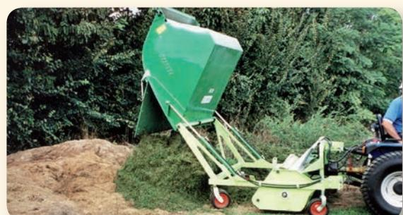
Scarico idraulico del raccolto.
