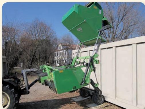
Scarico in altezza fino a 2,20 mt. con due coppie di prese idrauliche a doppio effetto.
