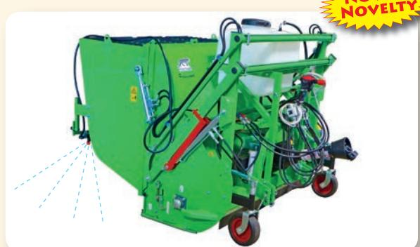
**Kit Bio-Fertilizzante** per la rigenerazione il tappeto erboso: Da assemblare su Panther e Panther Professional con sistema a pompa elettrica con agitatore e interruttore per utilizzo su trattore. Bio-Fertilizzante consigliato da ditta: [www.biozeta.it](http://www.biozeta.it) - [info@biozeta.it](mailto:info@biozeta.it)
